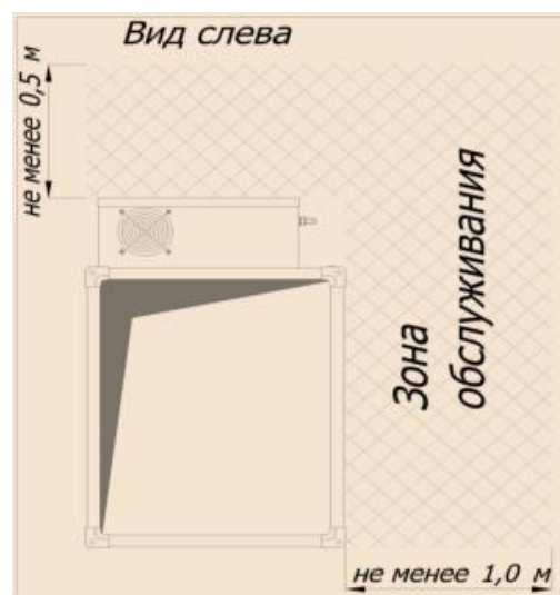
Рис. 7. Зона обслуживания Газоконвертора
